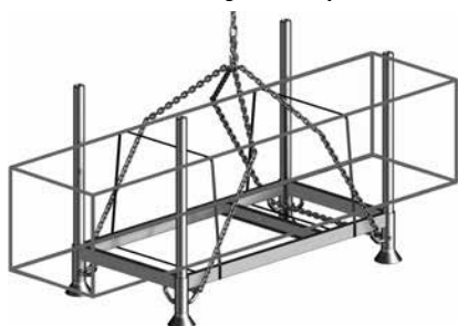
Palette avec anneaux ouverts : levage en panier
