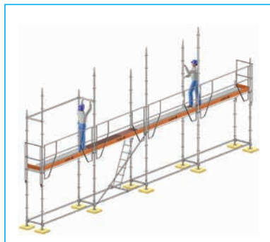
(4) Accès au 1 er étage et mise en place des montants et des plinthes du 1 er étage.
