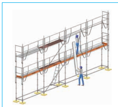
(7) Mise en place des planchers du 2 e étage à partir du 1 er étage.
