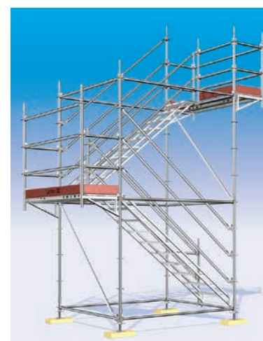
Escalier chantier à volées acier 4 pieds Largeur 2,07 m. Volée longueur 2,57 m. Existe en version 8 pieds.
