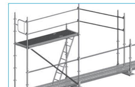
Faire glisser les lisses dans votre main, les fixer sur le montant opposé et fermer les clips.
