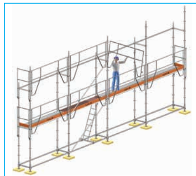
(5) Amarrage et mise en place du pare-gravois, si nécessaire, puis du garde-corps de sécurité du 2 e étage.
