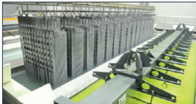
Le nouveau plancher LW bénéficie, comme ses prédécesseurs, d'une galvanisation à chaud 80 microns réalisée dans notre site de production.
