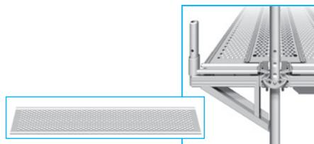
Les tôles perforées de recouvrement combrent efficacement les espaces entre planchers pour toutes les longueurs de 0,73 m à 3,07 m (réf. 3881.000 à 3881.005). Elles sont fixées par 4 vis (Réf. 3800.012)
