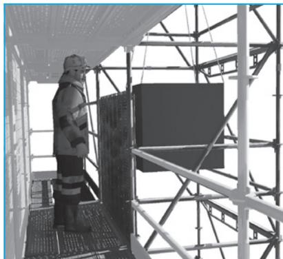
Le plancher rabattable couvre la surface totale de la sapine (profondeur 1,57 m maximum), vous permettant de poser des éléments volumineux. Le plancher une fois relevé assure la fonction de garde-corps.
