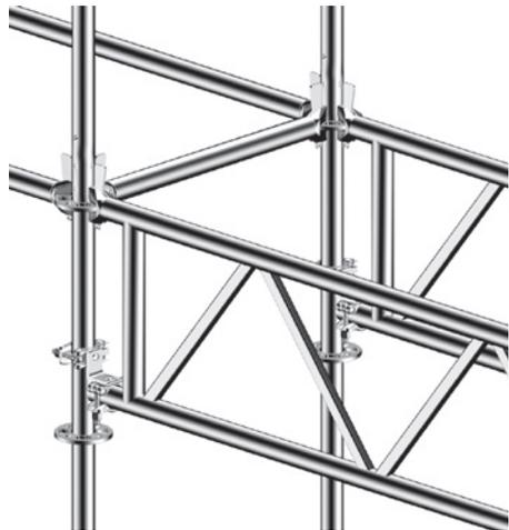
**18** Franchissement avec des poutres comportant sur la membrure supérieure deux têtes à clavette. La membrure inférieure est reliée aux poteaux avec des colliers de liaison de poutres + laçage anti-flambement (voir page 16).
