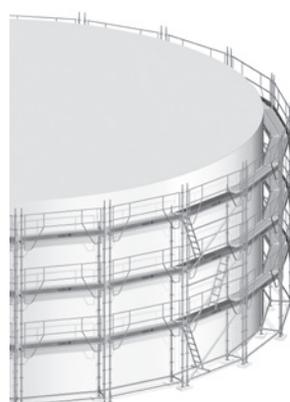
Pour des angles importants, les vides peuvent être sécurisés par le plancher de recouvrement pour échafaudage circulaire (détail 2).
