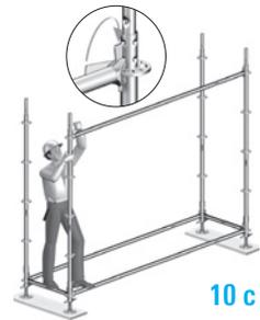
**10** Le montage des moises peut se faire seul en toute sécurité en bloquant la clavette à l'intérieur de la mâchoire (10 a) pour positionner la moise provisoirement, avant de verrouiller la mâchoire sur le disque (10 c) de manière classique ou utiliser le principe autolock avec les moises LW.
