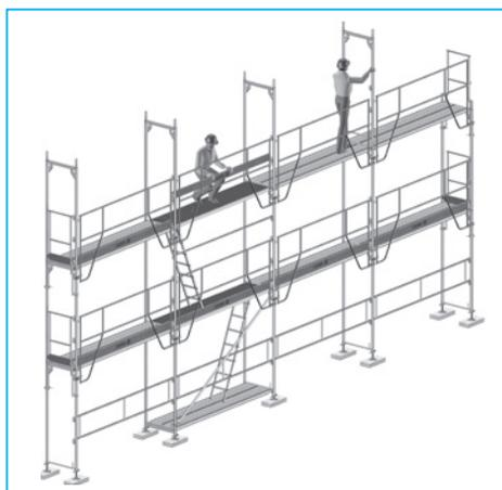
**8** Le montage de l'étage 2 continue avec les cadres et plinthes.
