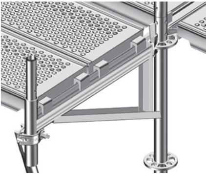
**15** Élargissement de la plate-forme de travail, exactement au même niveau, avec des consoles 0,390 m, 0,732 m ou 1,088 m. Puis mise en place des joints de sécurité sur les consoles.
