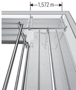
Pour pallier un débord de la façade, la largeur de plancher est augmentée par la mise en place de consoles 0,732 m, avec une maille supplémentaire de 1,572 m.
