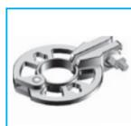
Très pratique, le **disque d'adaptation provisoire** permet de reprendre moises et diagonales à n'importe quel endroit du montant. Néanmoins, sa capacité au glissement est limitée à 1000 daN.
