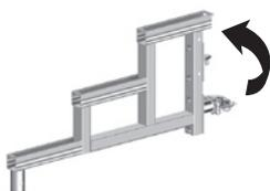
Le réglage entre la hauteur des planchers scène et celle des planchers acier se réalise d'une simple inversion du système de fixation boulonnée sur le limon.
