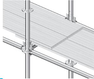
**9** Planches\* bois se recouvrant sur les traverses. La portée libre doit être inférieure ou égale à 1,50 m. (Fixer les planches sur les moises).
