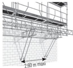
Le montage devra être réalisé en sécurité à l'aide d'un échafaudage complémentaire jusqu'au premier plancher.
