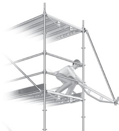
2 Grâce à sa tête articulée, on peut fixer la poutrelle U puis pousser l'ensemble pour assurer la liaison sur le disque.
