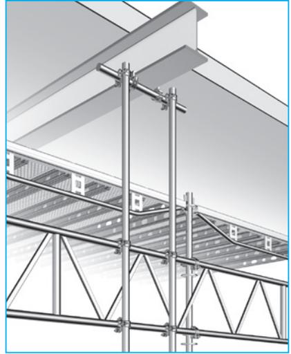
Le montant vertical doit être fixé par un collier orthogonal à moins de 10 cm du profilé support. La descente de charge dans ce montant ne doit pas excéder 900 daN pour éviter le glissement du collier.
