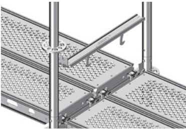
**7** Planchers en acier galvanisé à chaud, percés de trous pour les rendre antidérapants. Ils s'accrochent dans les supports-planchers.
