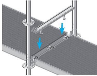
**8** Le joint de sécurité prévient, après rabat de la plaquette de blocage, le soulèvement des planchers et assure leur continuité.
