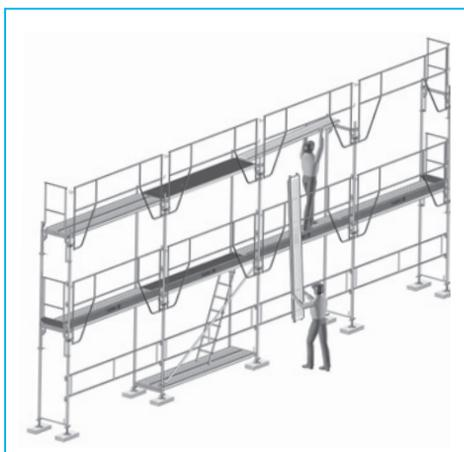
**7** Mise en place des planchers du 2<sup>e</sup> étage à partir du 1<sup>er</sup> étage.
