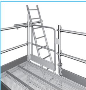
L'accès au niveau de travail est sécurisé par des portillons à fermeture automatique, équipés ou non de plinthe.
